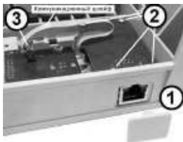
Рис. Ж.1 Порядок установки адаптера
