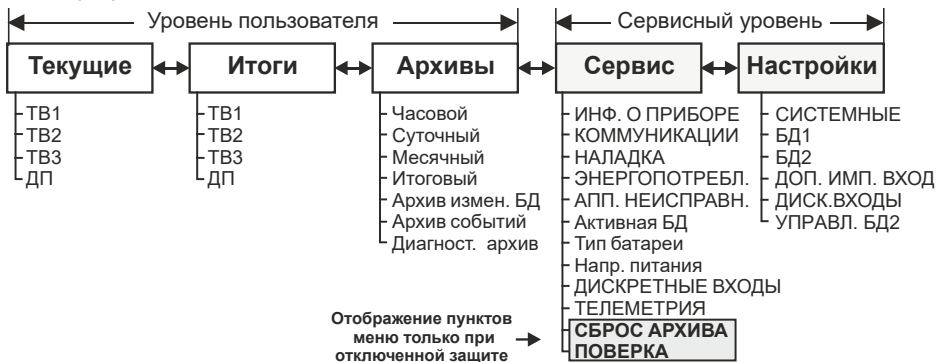
Рис. 2.6 – Структура меню тепловычислителя
