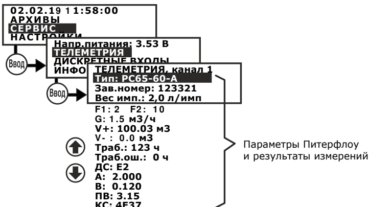
Рис. 3.11 – Порядок просмотра состояния расходомера
