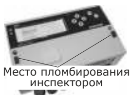
Рис. 1.2– Места пломбирования вычислителя
