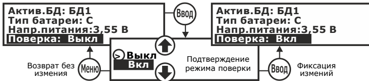
Рис. 3.16 – Включение режима проверки
