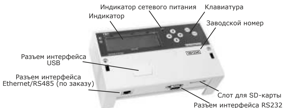
Рис. 2.1 – Внешний вид приборного отсека ТВ7 (вид сверху)
