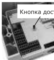
Рис. 3.2 – Расположение кнопки доступа
